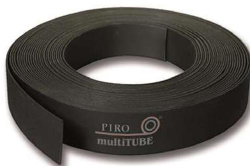
La banda Piro MULTITUBE PM está destinada al sellado ignífugo de pasos de instalación a través de paredes o techos de tuberías inflamables y tuberías no inflamables, aisladas con espuma aislante sintética inflamable de tipo PE o FEF, así como tuberías inflamables aisladas con lana mineral. También se utiliza para sellar haces de cables que atraviesan techos o paredes.
