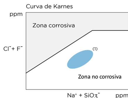
Nota: los análisis químicos de iones realizados según las normas ASTM C-795 y C-871 demuestran que los productos de Lana de Roca ISOVER no provocan la corrosión en el acero ya que la relación de iones F<sup>-</sup> + Cl<sup>-</sup> respecto a los Na<sup>+</sup> + SiO<sub>3</sub><sup>-</sup> se sitúa en la parte inferior de la Curva de Karnes.
