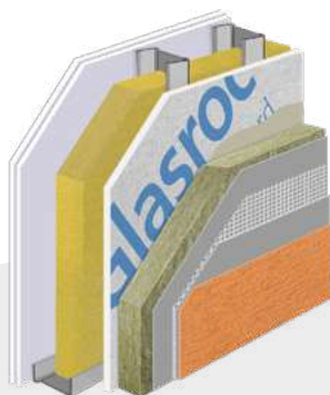
Muro exterior de hoja simple con SATE.
