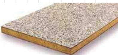
Panel sándwich compuesto de dos estratos, de 5 mm de espesor cada uno, de viruta gruesa de madera (abeto), aglomerado con cemento Portland blanco, firmemente adheridos a un estrato interno de lana de roca de alta densidad, orientada e incombustible. USOS: Falsos techos y revestimientos de gran absorción acústica. Aislamiento acústico. Resistencia al fuego. Aislamiento de tejados planos e inclinados.
