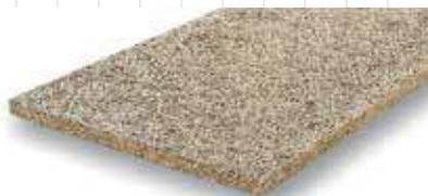
Panel de construcción de viruta gruesa de madera (abeto), aglomerado con cemento Portland gris. USOS: Eliminación de puentes térmicos en pilares, dinteles, bordones de estructuras, fondos de radiadores. Aislamiento acústico de paredes. Protección contra el fuego de techos y paredes. Encofrados.
