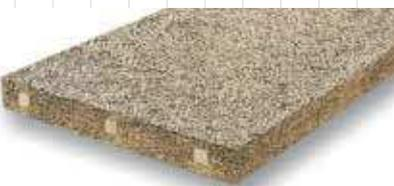
Panel de viruta gruesa de madera (abeto), aglomerado con cemento Portland gris, reforzado con tres listones de madera. USOS: Cubiertas transpirables, resistentes al fuego con acabados vistos. Soporte para enyesado y otros revestimientos. Soporte para suelos de madera. En todas las construcciones compatibles con la bioarquitectura.
