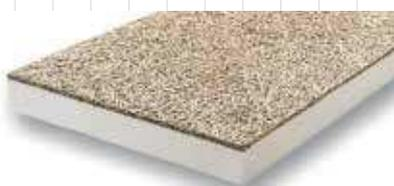
Panel compuesto de un estrato de 10 mm de espesor de viruta gruesa de madera (abeto), aglomerado con cemento Portland blanco, firmemente adherido a otro estrato de poliestireno ignífugo. USOS: Aislamiento de pavimentos y desvanes, tejados planos e inclinados. Falsos techos de elevado aislamiento y ligereza. Revestimiento aislante de sótanos y pórticos.
