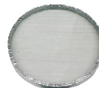
La instalación de los vidrios del ojo de buey en exteriores puede provocar opacidad en los mismos por la acción del sol y de temperatura.
