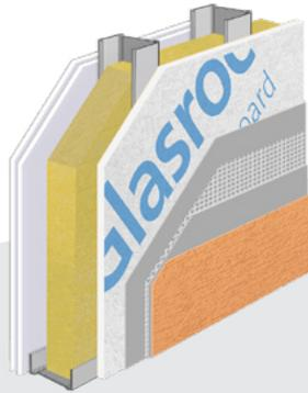
Muro exterior de hoja simple con acabado de mortero o pintura.
