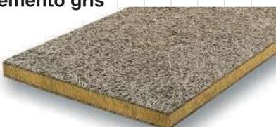
Panel sándwich compuesto de dos estratos, de 5 mm de espesor cada uno, de viruta gruesa de madera (abeto), aglomerado con cemento Portland gris, firmemente adheridos a un estrato interno de lana de roca de alta densidad, orientada e incombustible. USOS: Revestimientos de gran absorción acústica. Aislamiento acústico. Resistencia al fuego. Aislamiento de techos planos e inclinados.
