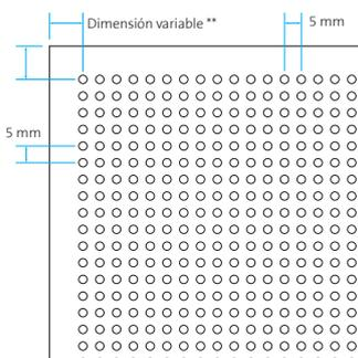
Perforación  $\varnothing$  2,5 mm
