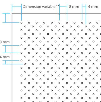
Perforación  $\varnothing$  1,5 mm
