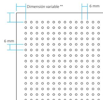
Perforación  $\varnothing$  2 mm
