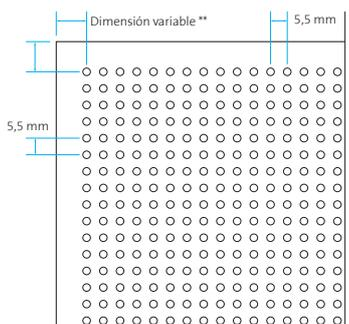
Perforación  $\varnothing$  2,5 mm
