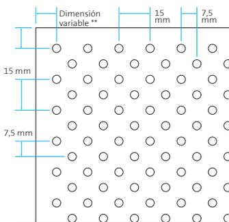
Perforación  $\varnothing$  4 mm
