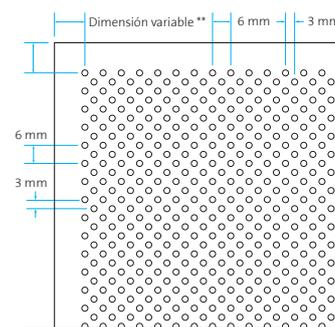
Perforación  $\varnothing$  2 mm
