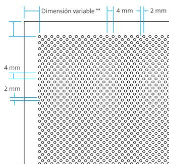
Perforación  $\varnothing$  1,5 mm
