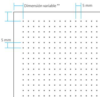
Perforación ultra-micro  $\varnothing$  0,7 mm
