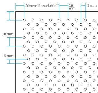
Perforación  $\varnothing$  2,5 mm
