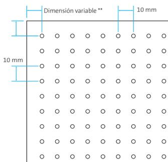
Perforación  $\varnothing$  2,5 mm
