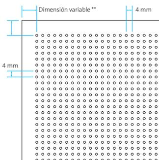
Perforación  $\varnothing$  1,5 mm
