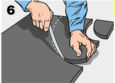
Colocar sobre el reverso de una plancha la pieza obtenida y trazar la sección correspondiente opuesta. Después, cortar esta nueva sección.
