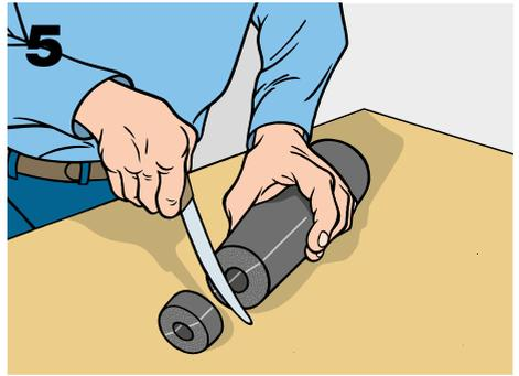
Si fuera necesario, recorte también el extremo más ancho, para insertar la pieza entre las tuberías ya aisladas.
