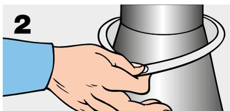
Trasladar todas las medidas (ambos diámetros y longitud de la reducción) a la plancha K-FLEX, luego trazar dos líneas desde los extremos hasta que se junten en un mismo punto.
