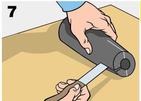
Después de haberlo colocado en su sitio, aplicar adhesivo K-FLEX en el corte y todos los extremos de las coquillas y pegar.
