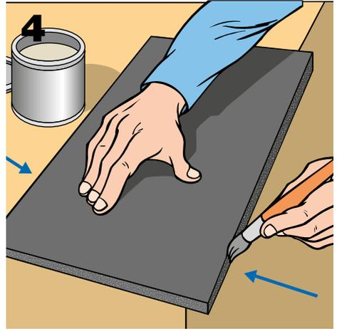
Envolver con la plancha la tubería y unir los bordes encolados, empezando por los extremos, posteriormente el centro y sucesivamente, los puntos intermedios.
