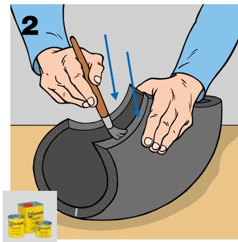
Colocar la pieza sobre el codo a aislar.
