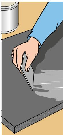
Para extender el adhesivo en grandes superficies, es posible utilizar una espátula. En el caso que haya que pegar toda una superficie, se debe comenzar primero por la plancha de K-FLEX y después la superficie a aislar. Una vez transcurrido el tiempo de secado, se colocará la plancha sobre la superficie a aislar.
