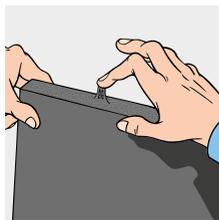
Después de haber aplicado el adhesivo en el tubo o plancha K-Flex, se debe tener en cuenta que debe estar bien seco antes de pegarse. La prueba del dedo es la más práctica: basta con tocar la superficie encolada para ver que al despegarlo no se producen filamentos. En este punto el aislamiento encolado está listo para colocarse.
