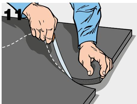
Realice un corte en ángulo (a modo de chaflán) en el borde interior de la pieza cortada anteriormente, para que se adapte mejor al recubrimiento de aislamiento exterior del cuerpo de la válvula.
