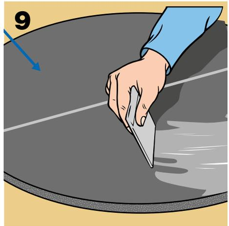
Dejar secar el adhesivo y juntar los bordes de la tapa con el recubrimiento cilíndrico, ejerciendo presión en los puntos de unión.
