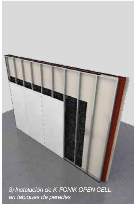
3) Instalación de K-FONIK OPEN CELL en tabiques de paredes
