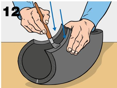
Coloque el aislamiento K-FLEX sobre la tubería y unir con fuerza los bordes encolados.
