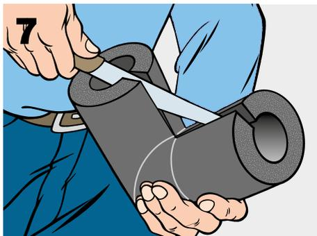
Montar el codo abierto en la zona a aislar y pegar presionando los bordes cortados.
