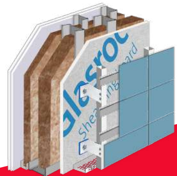
Muro exterior de hoja doble con fachada ventilada.
