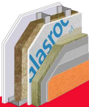
Muro exterior de hoja simple con SATE.
