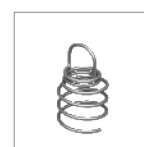
A - Fijación en espiral a 15 cm. de los cantos
